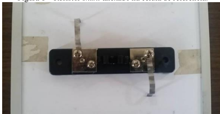
Figura 6 – Resistor shunt anexado na célula de referência.
