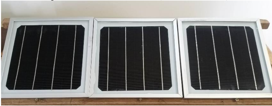
Figura 4 – Células de referência de m-Si (CEL 1, CEL 2 e CEL 3).
