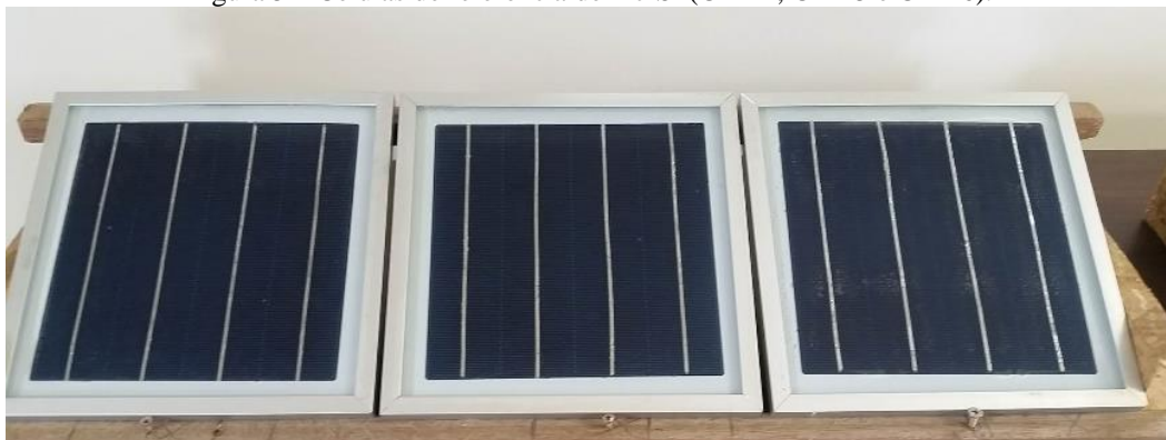
Figura 5 – Células de referência de mc-Si (CEL 4, CEL 5 e CEL 6).
