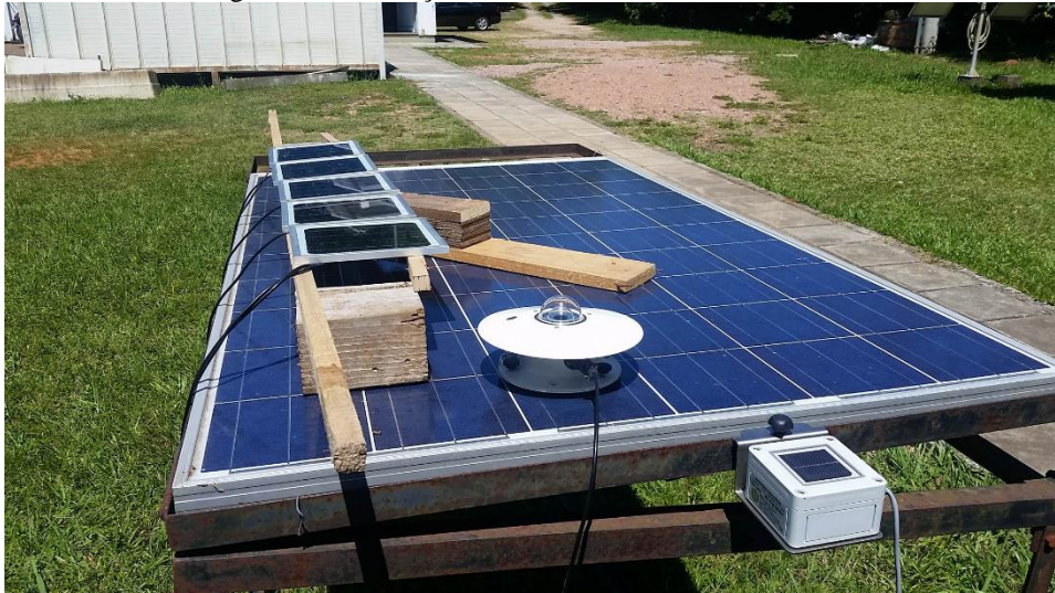
Figura 7 – Calibração outdoor das células de referência.
